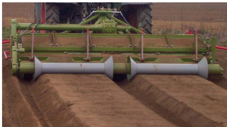
Рис. 1. Нарезание гряд гребнеобразователем «Базельер»
